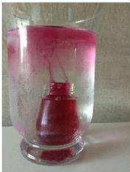
Figura 4: Resultados para o recipiente grande com água fria, e o recipiente pequeno com água quente (Fonte: ESA CCI)
