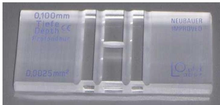
Figura 1 - Câmara de Neubauer (vista de topo).
