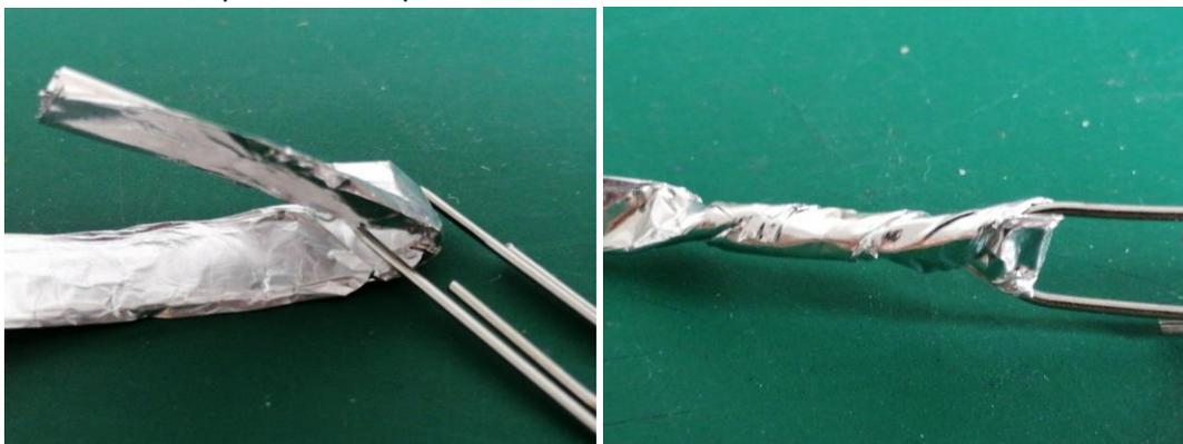
Repetir o processo na outra ponta da tira de alumínio e enrolar o "fio". No final deve ficar com um "fio" semelhante à imagem que se segue.
