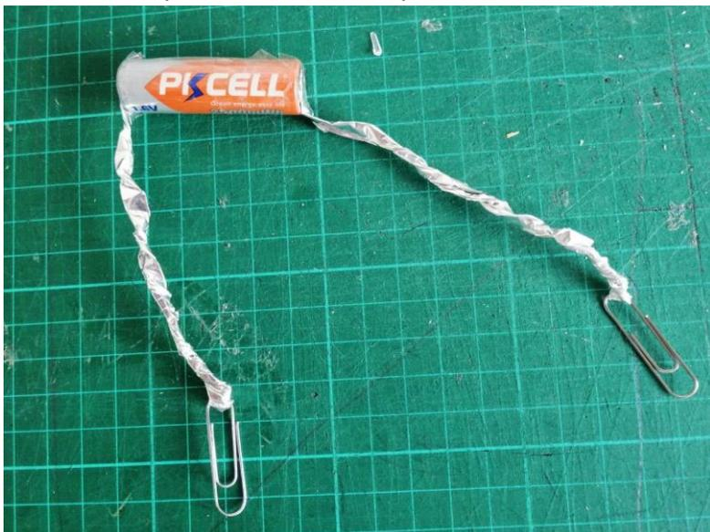
3. Experimentar acender o led utilizando apenas dois fios e a pilha de 3 V (ou duas pilhas de A/AA/AAA associadas em série). Pode fazer as ligações entre elementos do circuito utilizando molas ou encaixando os cliques nas molas;
